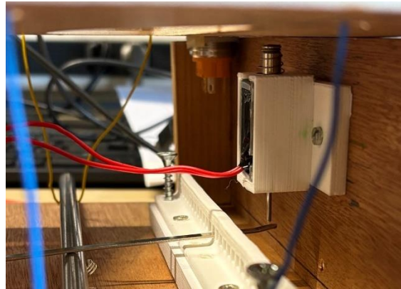
Figure 13 : Exemple de montage du solénoïde
