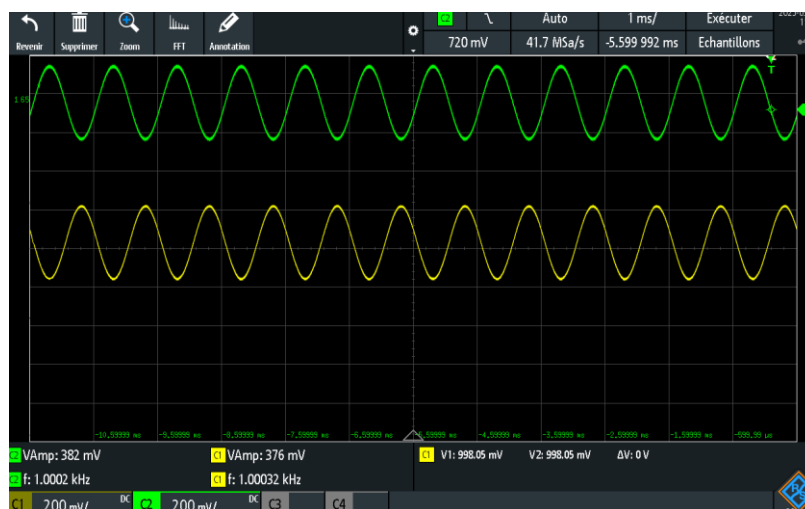
Figure 8 Offset : Signal entrée Offset 1.65V.
