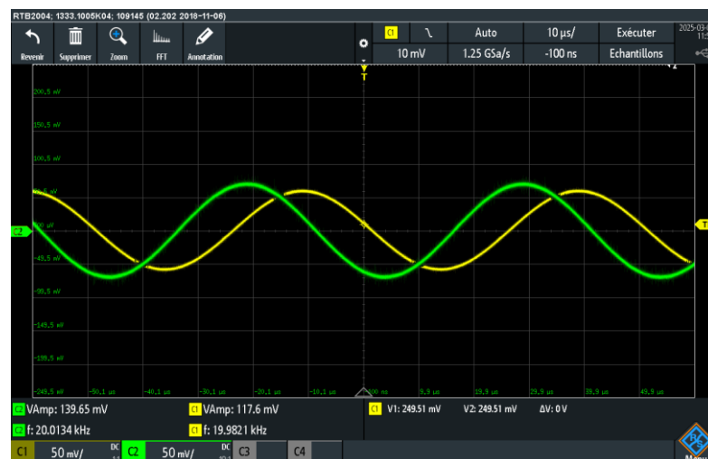
Figure 2 Filtre : Signal entrée sortie à 20kHz
